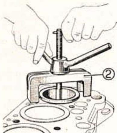
Fig. 4. — Extraction d'une chemise de cylindre
